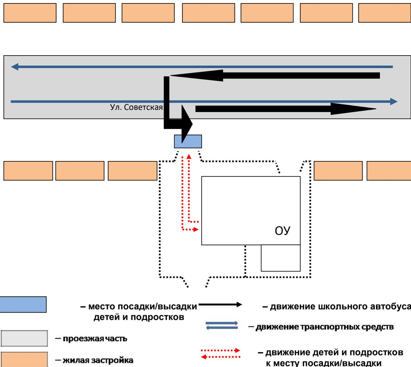
**III. 1. План-схема пути движения транспортных средств и детей при проведении дорожных ремонтно-строительных работ вблизи образовательной организации.**
